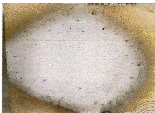
Fig.n°6: Muestra expuesta al fuego por 2h
