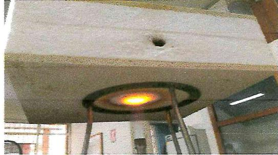
Fig. n°9 : Muestra durante el ensayo de resistencia al fuego.
